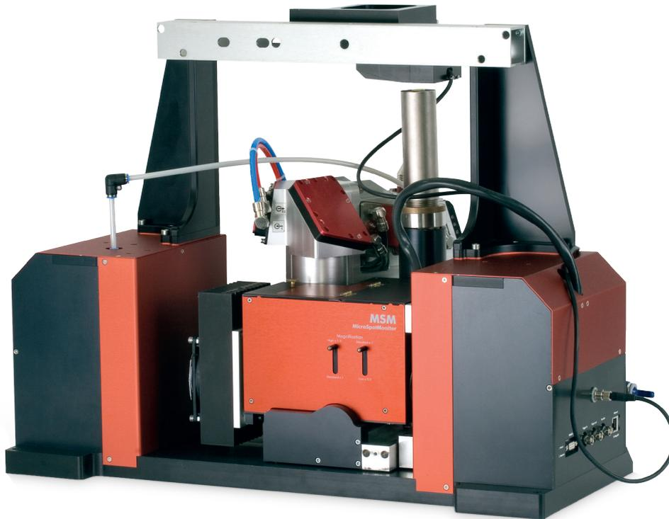
HighBrilliance(高輝度)用オプションを追加した高輝度ハイパワーレーザ向けMSM:HighPower-MSM-HighBrilliance (HP-MSM-HB)は、シングルモードレーザ最大10kWのパワー密度分布をフォーカルプレーンで直接測定できます。
