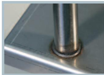
**Blechkonstruktionen:** Kehlnähte an 3D-Bauteilen oder Rohren
